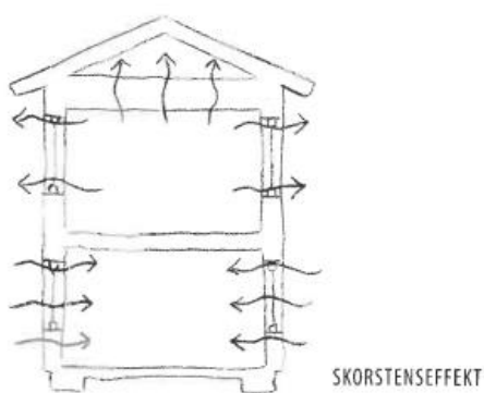
Figur 3.12 – Illustration av luftflöden till följd av temperaturskillnader i luft (Strandberg & Lavén 2018).
